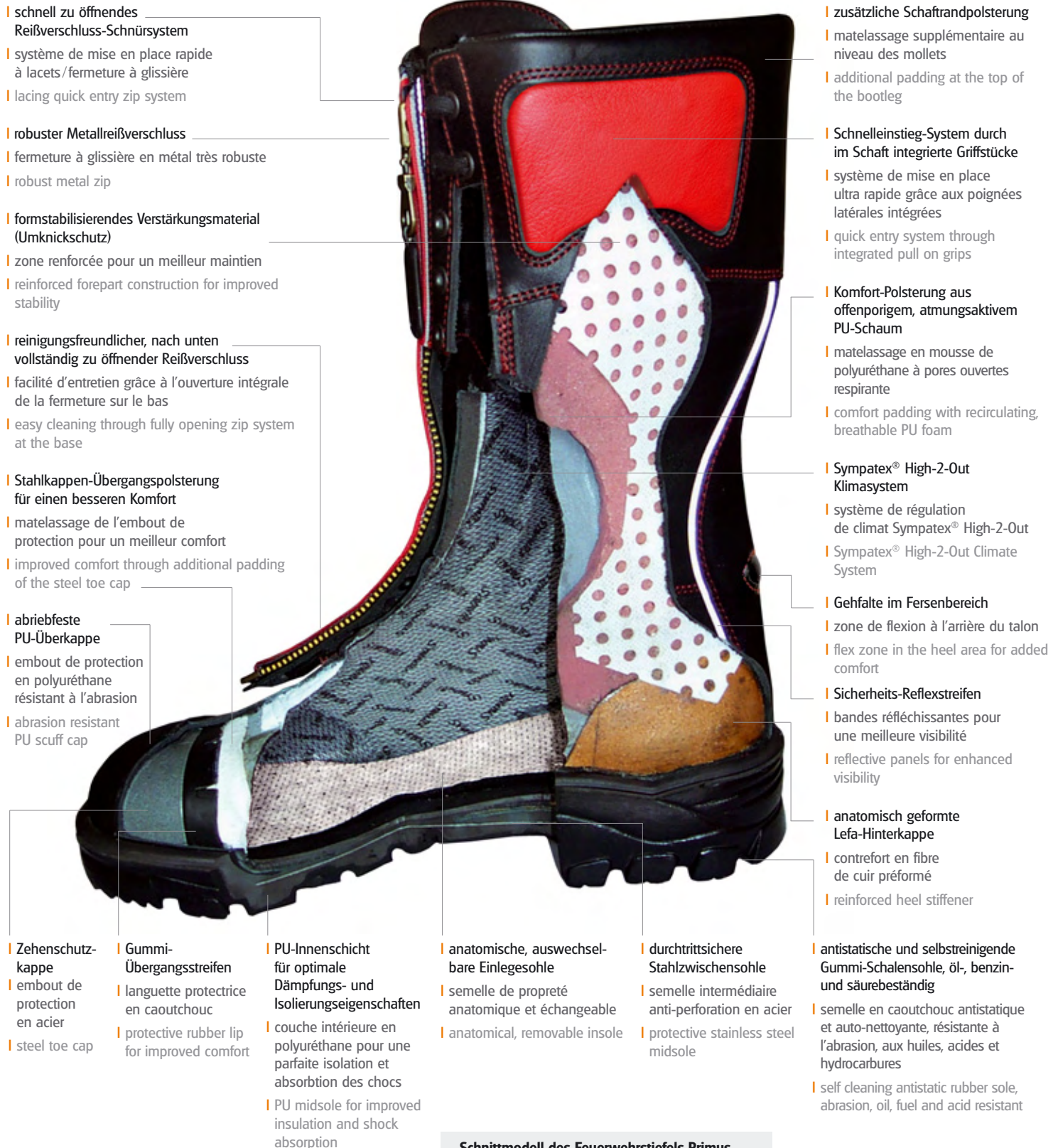
Schnittmodell des Feuerwehrstiefels Primus Coupe de la rangers Primus Cut away illustration of the Primus fire fighting boot
