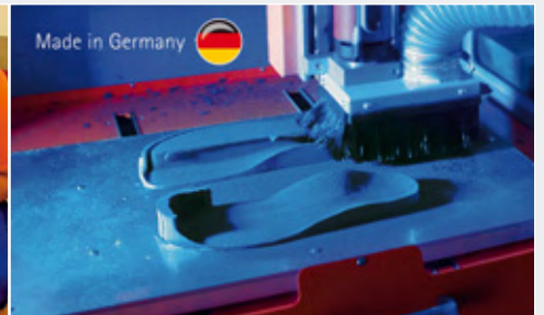
Fräsen der Einlagen | fraissage des semelles | milling of the insoles
